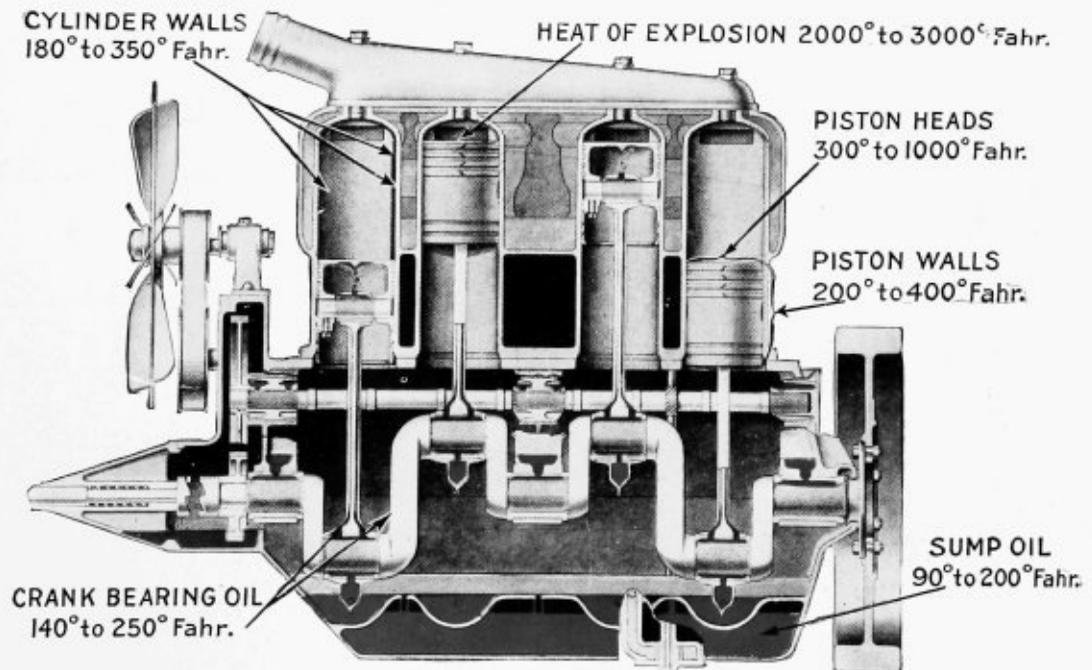
OPERATING TEMPERATURES OF MOTOR PARTS
