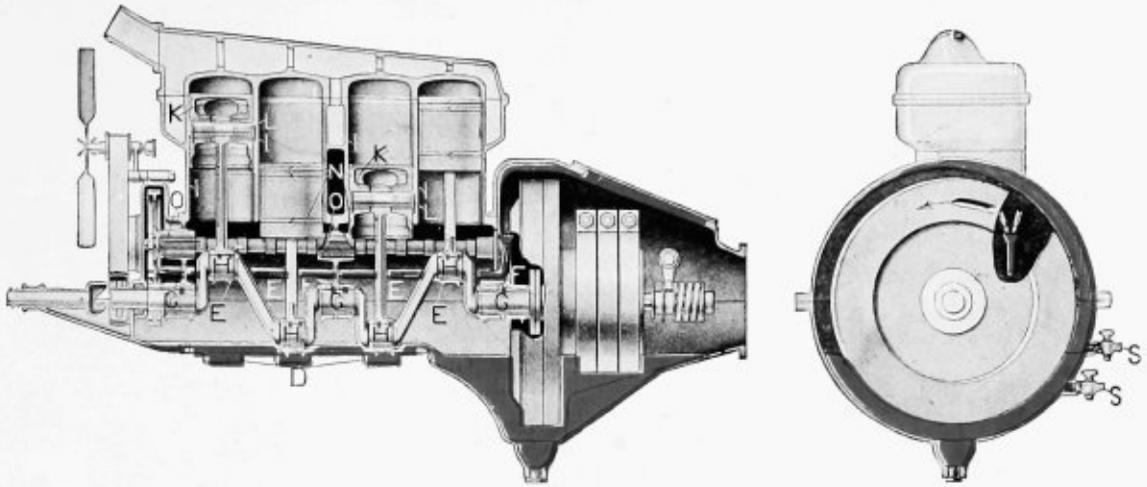
SYSTEM 1—THE LUBRICATING SYSTEM OF THE FORD MOTOR
