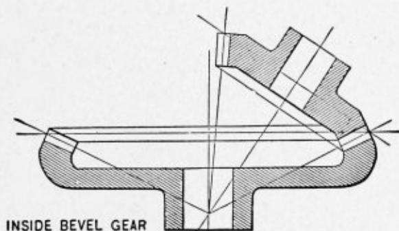
INSIDE BEVEL GEAR AND PINION
