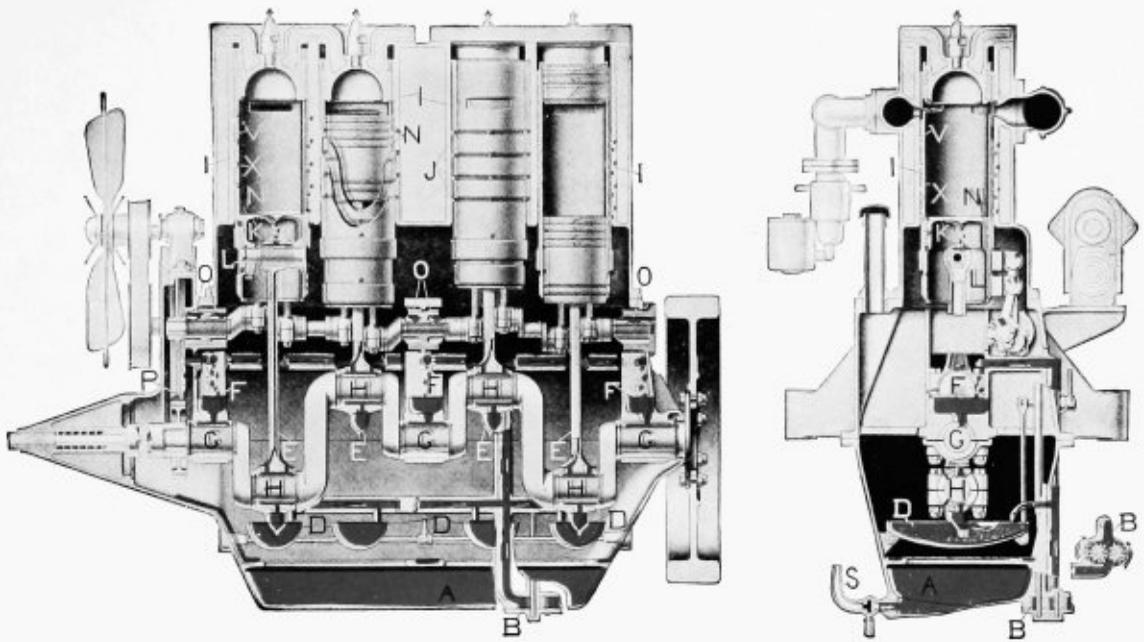
SYSTEM 9—KNIGHT SLEEVE VALVE MOTOR
