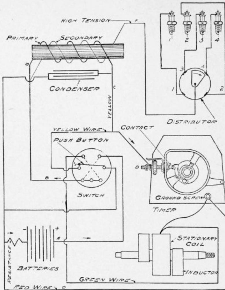
WIRING PLAN FOR REMY MAGNETO-TYPE CIRCUIT DUAL SYSTEM FOUR CYLINDERS
